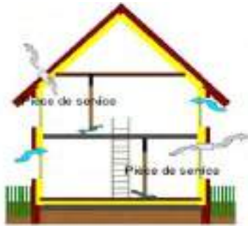
Schema de principe d'un système de ventilation naturelle avec balayage Fenêtres ouverte, <1960
