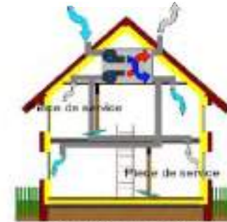
Schema de principe d'un système de ventilation mécanique double flux par extraction avec balayage et échangeur de chaleur. Fenêtres fermées.
