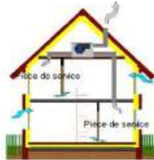
Schema de principe d'un système de ventilation mécanique simple flux par extraction avec balayage. Fenêtres entr'ouvertes., 1960
