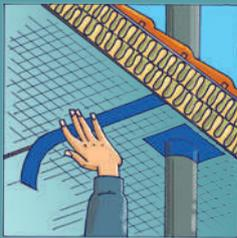
Passage de tuyaux rendu étanche grâce à une gaine et à des bandes adhésives spéciales. Les raccords entre les bandes de frein/pare-vapeur sont également rendus étanches grâce à des adhésifs spéciaux. Tout défaut de pose de cette fermeture permet à l'air intérieur chaud de s'échapper et augmente le risque de condensation à l'intérieur de la paroi (perte de performance de l'isolant, pourriture du support...).
