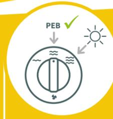
Je choisis **le bon groupe de ventilation**: les débits réglementaires sont idéalement respectés à 60% de la capacité du groupe (Position 2 sur 3). Ne pas oublier le rôle de la surventilation. Réserver une plage de surventilation dans la capacité du groupe.
