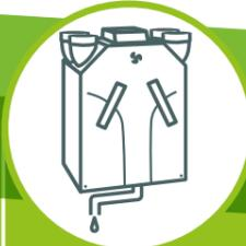
Pour m'assurer de la bonne pose de l'appareil, je vide une petite quantité d'eau dans le bac à condensat et en vérifie la **bonne évacuation**.
