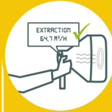
À la réception provisoire, je procède au **contrôle des débits de ventilation** de certaines bouches (ex : cuisine, salle de bains, séjour) afin de m'assurer que les débits nécessaires sont bien présents et que l'utilisateur ne souffrira pas des conséquences d'un mauvais réglage du système.
