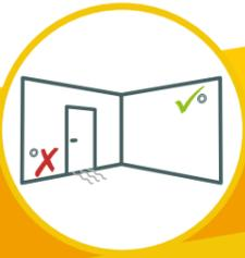
Lors de la conception de mon réseau, je place les bouches de ventilation à **bonne hauteur dans le local et suffisamment éloignées des ouvertures de transfert** afin de permettre un bon brassage du volume complet du local.
