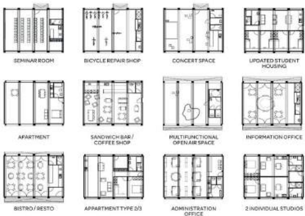
Figure 99. Plans relatifs aux différents scénarios d'utilisation (Source: Architectural Engineering, VUB)
