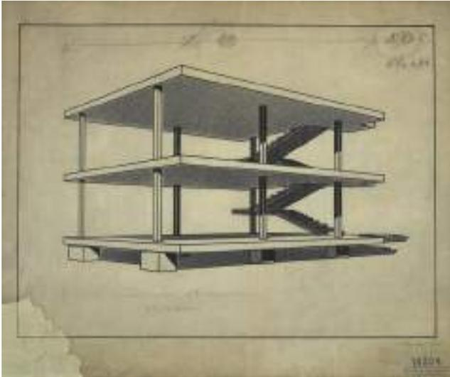
Système de structure – ossature – complément indépendant des fonctions du plan de la maison: cette ossature porte simplement les planchers et l'escalier
